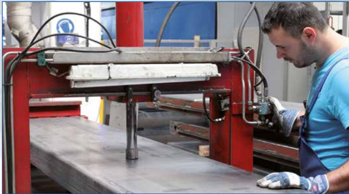
Option „Absetzvorrichtung“: Bei Hebebühnen für die Fahrwerksvermessung wird jede Fahrfläche im Bereich der Drehteller- und Schiebepplattenauflagen nach dem Schweißen auf einer Vorrichtung exakt eben gerichtet.
