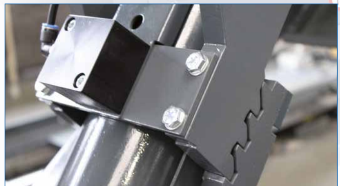
Die Rastverzahnung wird bei Hebebühnen für die Fahrwerksvermessung (Option „Absetzvorrichtung“) durch Fräsen gefertigt und sichert dadurch eine hohe Präzision auf unterschiedliche Arbeitshöhen.
