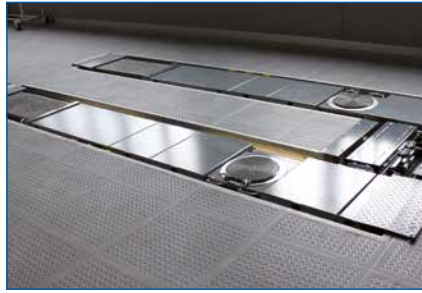
DUO CM im Streifenfundament (Ausstattung für Fahrwerksvermessung).
